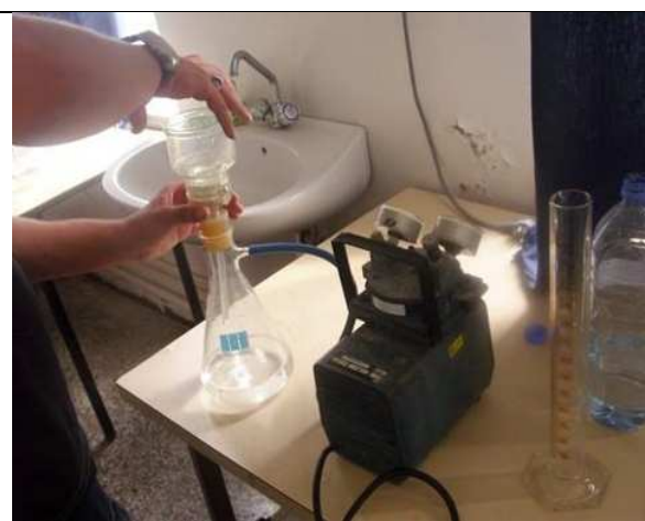
Fig.3.13 : Dispositif de filtration sous vide de marque Millipore ®
