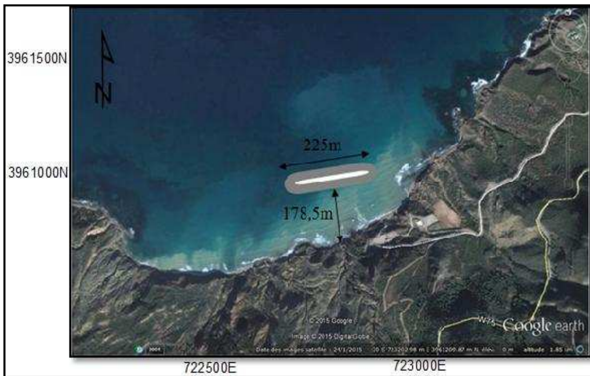
Figure n°49 : Installation du brise-lame dans la plage d'Ain Franine. (Google Earth, 2015)
