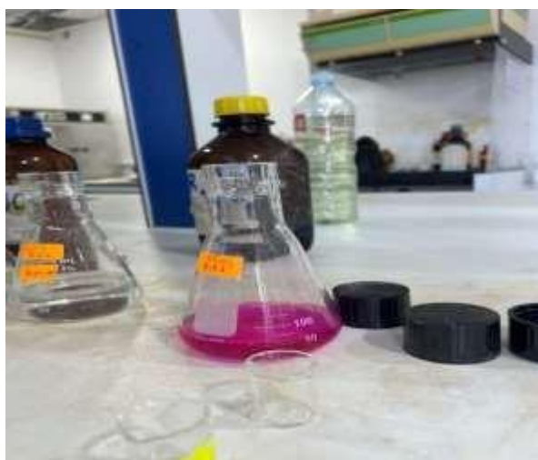
Figure 20. Développement de la coloration rose lors du dosage des nitrites ( \text{NO}_2^- ).
