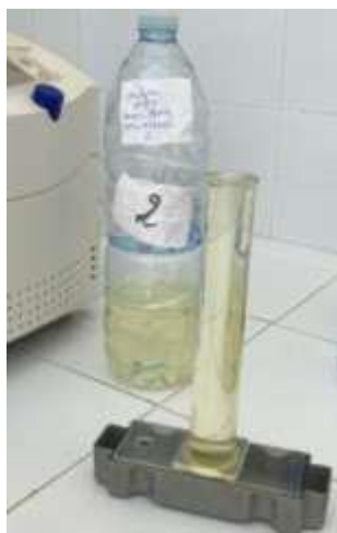
Figure 23. Chambre de sédimentation d'UTERMOHL.
