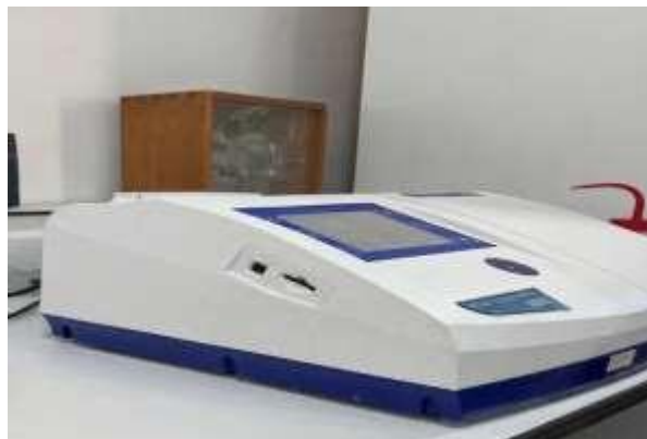
Figure 19. Spectrophotomètre UV-Visible utilisé pour l'analyse des nutriments.
