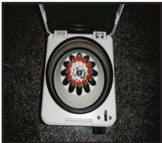
Figure 3.13 : Centrifugeuse Hettich ZENTRIFUGEN de type EBA 30
