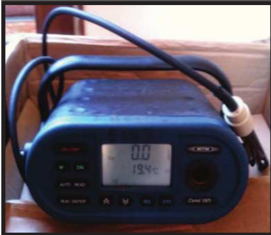
Figure 3.9 : conductimètre de type WTW cond 197i
