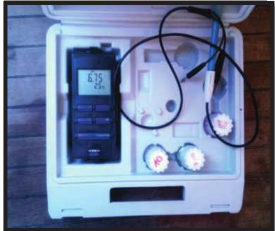
Figure 3.10 : pH mètre de type WTW pH 315i
