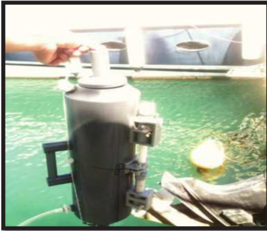
Figure 3.7: bouteille de prélèvement d'eau de mer de type NISKIN
