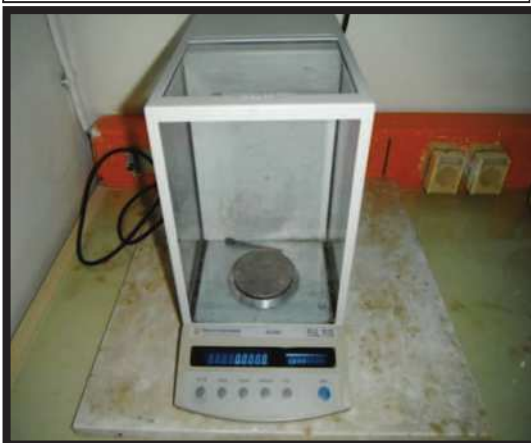
Figure 3.12 : Balance de marque Denver Instrument® modèle M-220D
