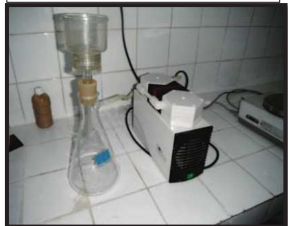
Figure 3.11 : Système de filtration sous vide de marque Millipore® .
