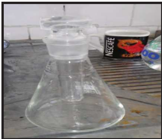
Figure 3.16 : Flacon en verre borosilicate à bouchon plongeant
