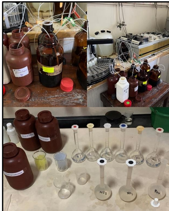
Figure 24: Dosage des sels nutritifs par méthode Skalar, (1998)
