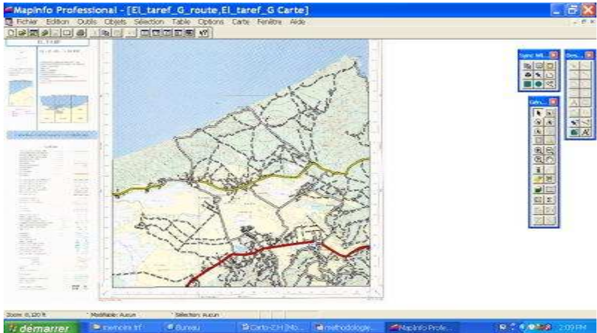
Figure N°19: Représentation du dessin de la couche du réseau routier sur la carte numérisée d’El Taref Est.
