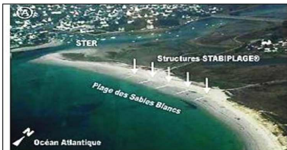
Figure IV. 5 : Vue aérienne des 5 Stabiplage transverses mis en place sur la plage des Sables Blancs (France).
