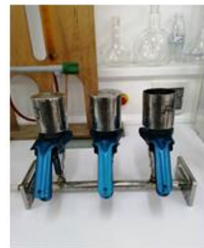
Rompe de filtration
