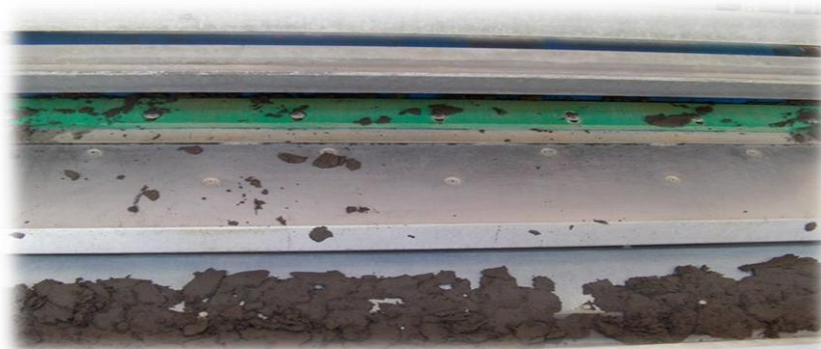
Figure III.13 : la déshydratation mécanique.
