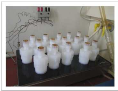
Figure I.15: Minéralisation de sédiments pour le dosage des Métaux lourds
