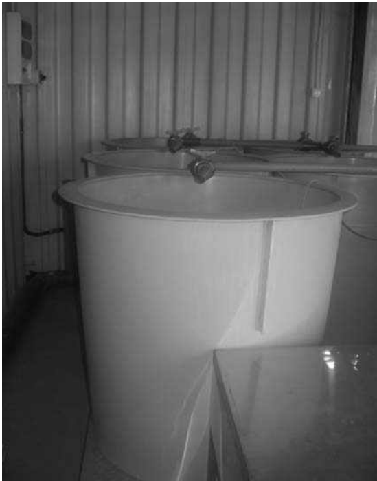
Figure 17 à gauche : Série de bacs pour larves avec leur système d'alimentation en eau.
