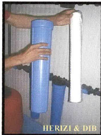
Figure 42: Filtre à cartouche (AQUATAFNA., 2007)
