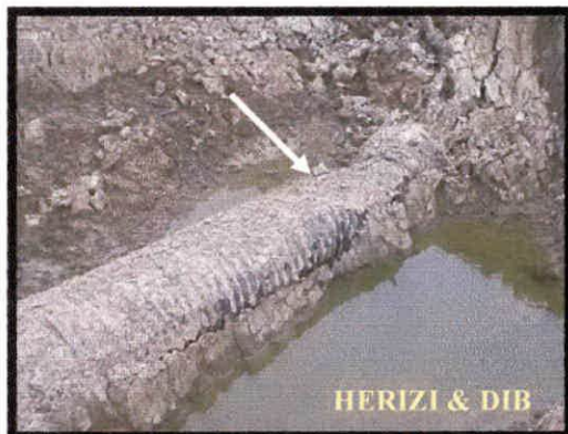
Figure 31 : Tuyaux d'approvisionnement en eau de mer endommagés (AQUATAFNA ,2007)
