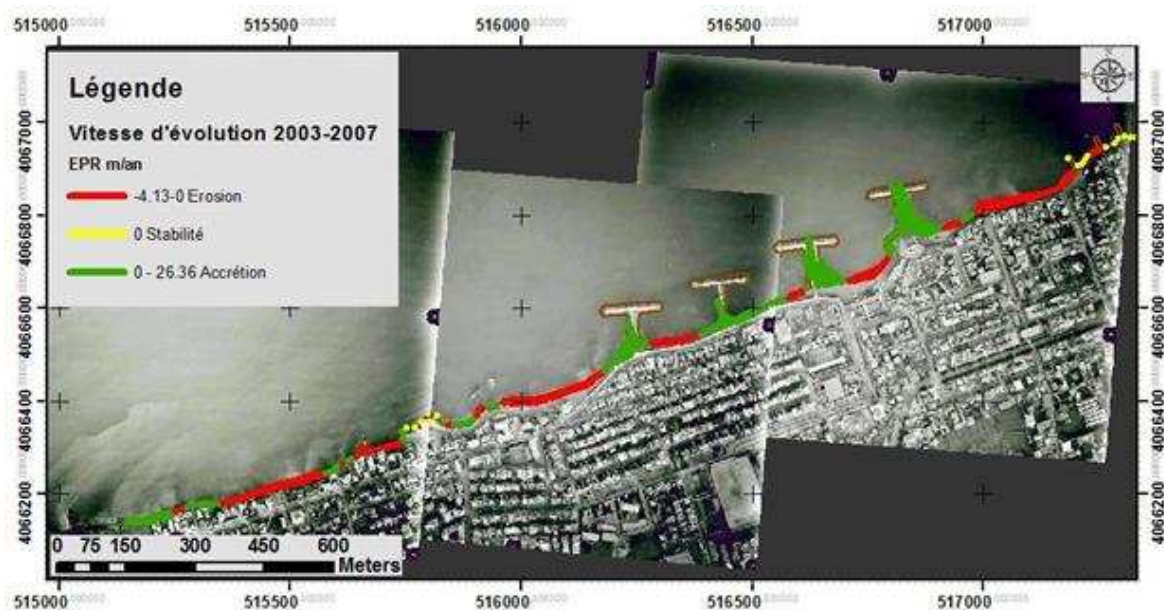
Figure V.2: Vitesse d'évolution du trait de côte entre 2003 et 2007 dans la zone de Bordj EL Kiffan (AOUDJ et al, 2018)
