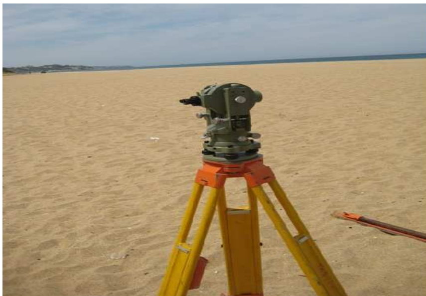
Photo 13 : Théodolite Wild RDS. 310617 , utilisé pour les relevés topographiques.
