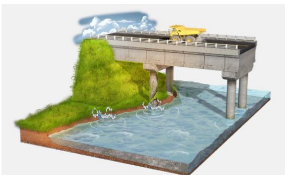
Figure 5: Avant la construction de système de protection anti-affouillement.
