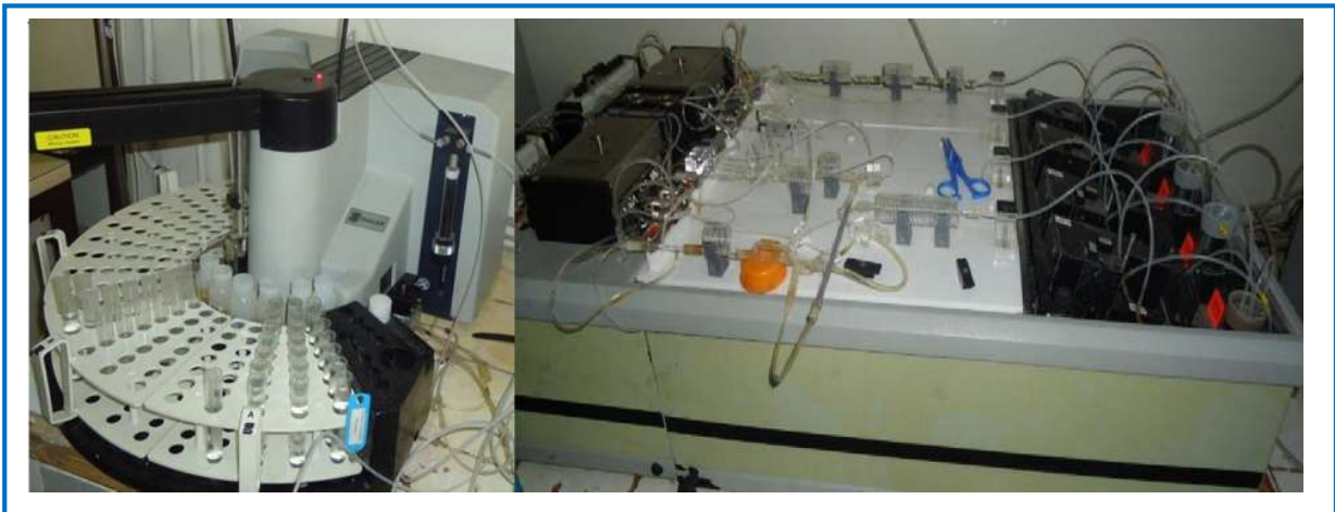
Figure 17 : Auto Analyser San Plus (SKALAR®, 1998).
