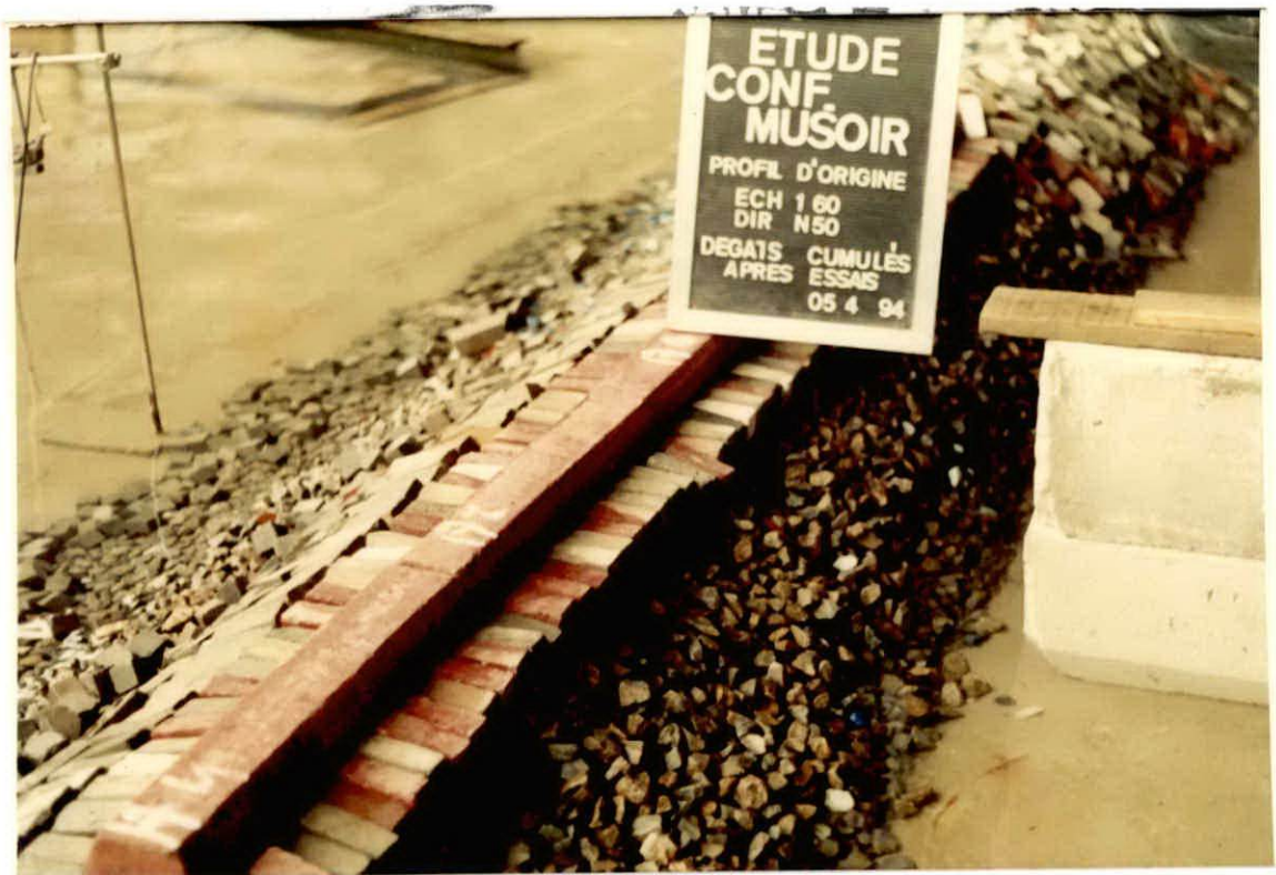
PHOTO 10 : Vue du talus interieur, profil d'origine direction N50° après essais, érosion importante
