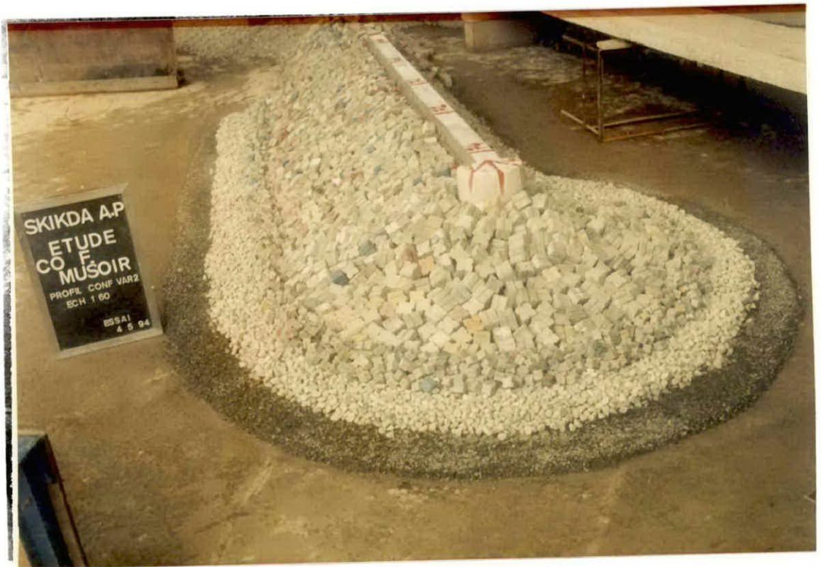
PHOTO 22 : Vue du Musoir et de la partie courante, variante 2 avant essais.
