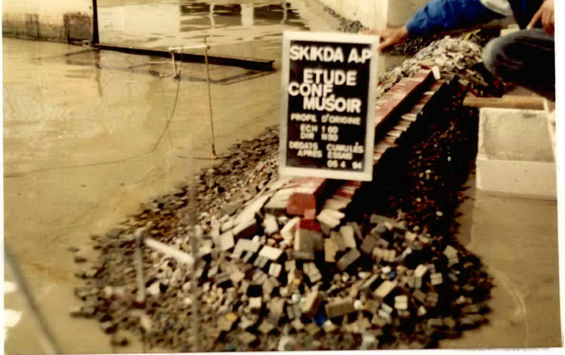
PHOTO 9: Vue du Musoir, profil d'origine, direction N50° après essais (Hs=8,6M, T p =15s).
