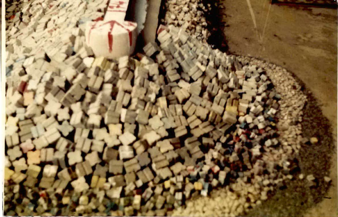
PHOTO 31 : Vue du Musour, variante 3, après essais, légers dégats en butée côté intérieur.
