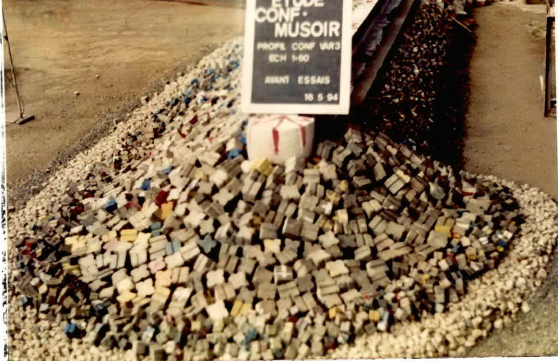
PHOTO 25 : Profil conforté, variante 3 élargissement de la dalle de couronnement de 8m et rechargement du talus arrière avec des enrochements de ( 3-6)t avant essais.
