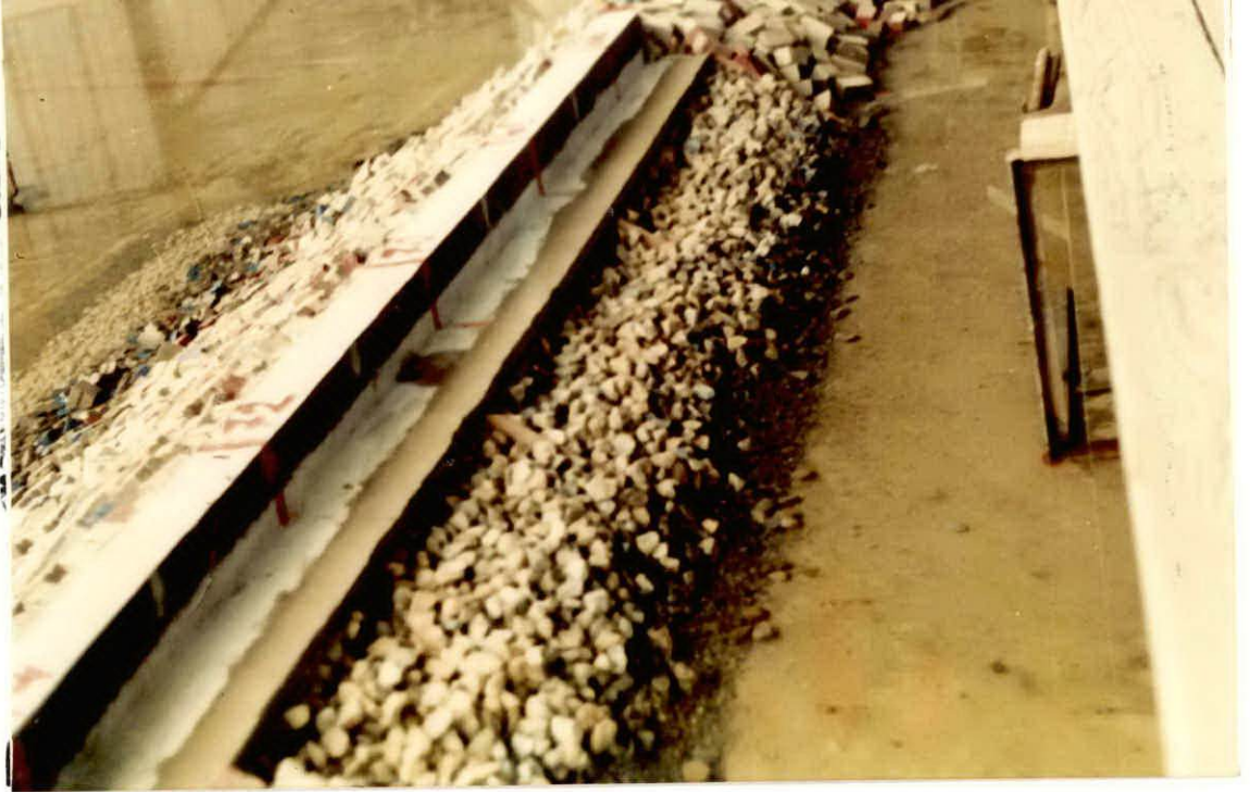
PHOTO 29 : Vue talus intérieur, variante 3, après essais, (Hs=10m, Tp=10s). Talus intérieur stable, légèrement érosé en crête.
