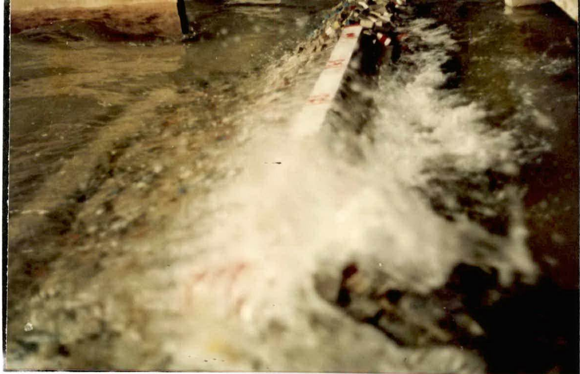
PHOTO 27 : Franchissements énormes, variante 3, direction N26° essai 8 (Es=10,02m, Tp=11's).
