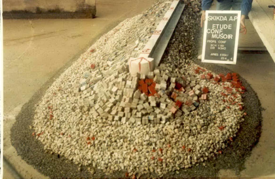
PHOTO 17 : Vue générale, variante 1 direction N 31°0 après essais, (Hs= 9,72m, Tp= 15s). Dégats localisés côté intérieur du musoir.
