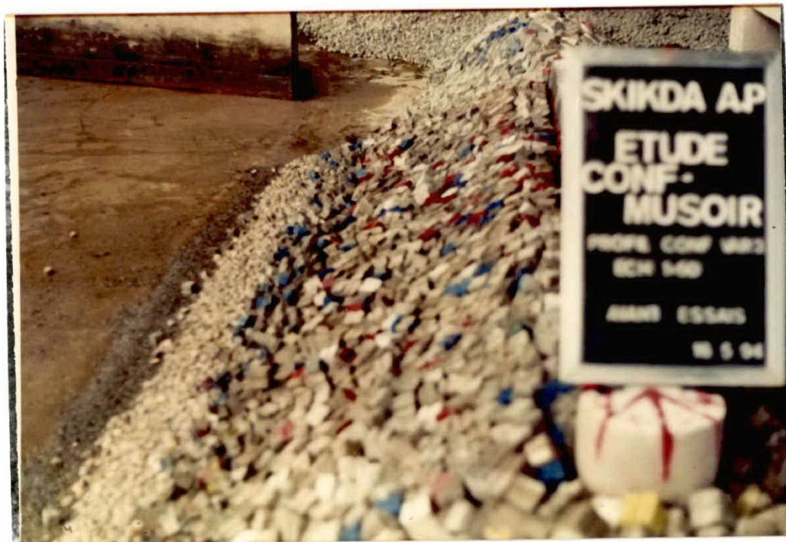
PHOTO 26 : Vue de la partie courante, variante 3 avant essais. ( Variante recommandée).
