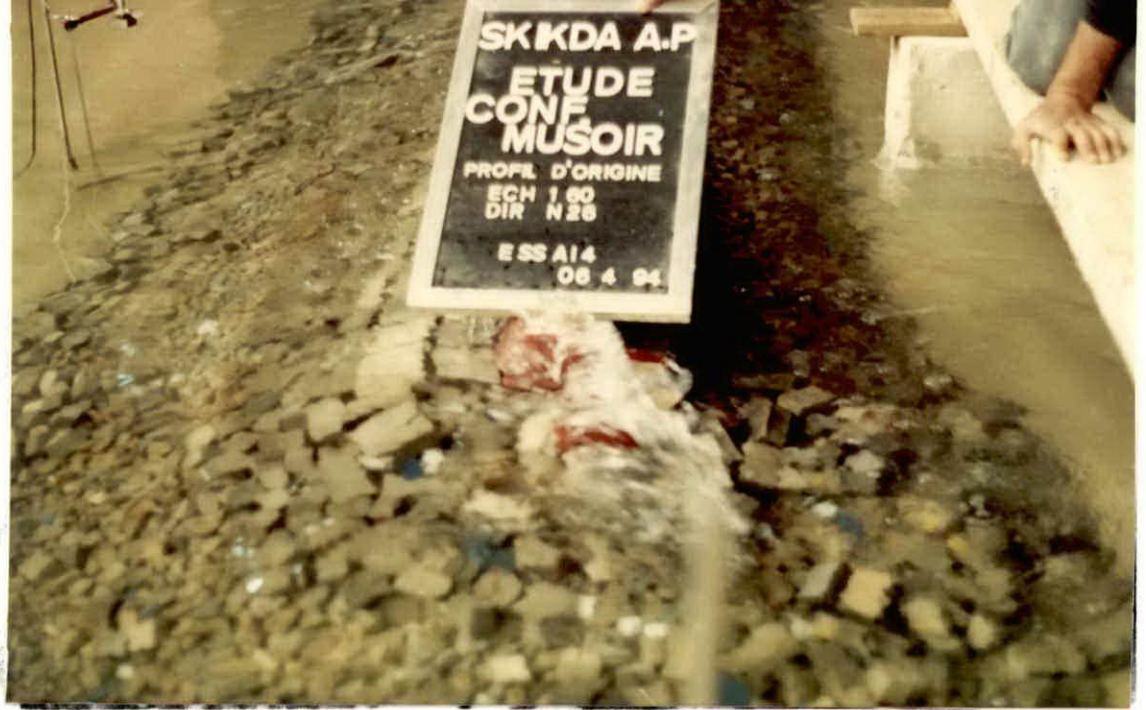
PHOTO 11 : Vue du Musoir et de la carapace profil d'origine direction N26, essai 4 (Hs=1,92m, Tp=12s).
