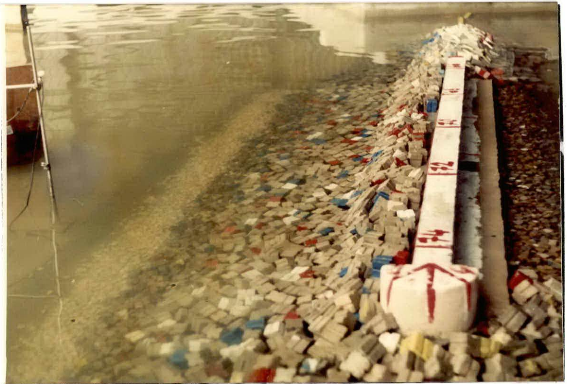
PHOTO 30 : Vue de la carapace, variante 3 après essais (Profil stable).
