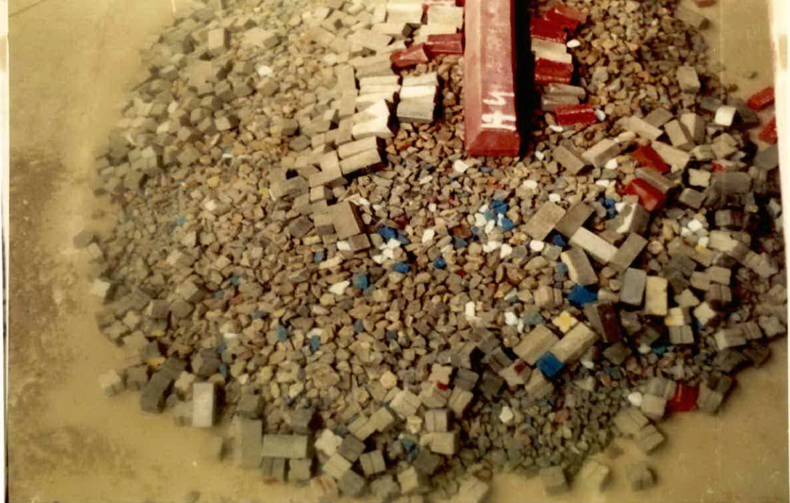
PHOTO 13 : Vue du Mueoir, profil d'origine, direction N30° après essais (Hs=9,32m , Tp=15s). desorganisation totale du Mueoir.
