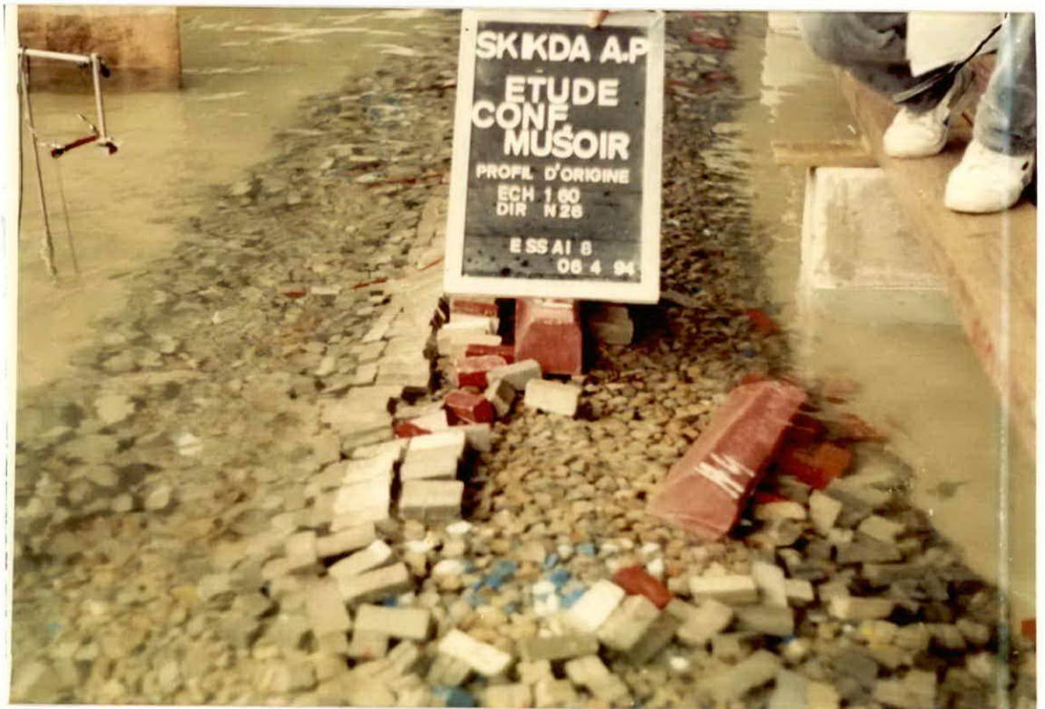
PHOTO 12 : Vue du Musoir et de la carapace, profil d'origine direction N26, essai 8 (Hs=8,1m, Tp=10s) destruction totale du Musoir.
