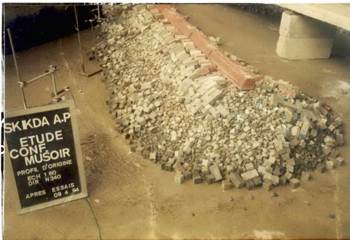
PHOTO 14 : Vue du Mueoir et de la carapace, profil d'origine direction N30° après essais dégats très important du Mueoir. (Hs=9,32m , Tp=15s).
