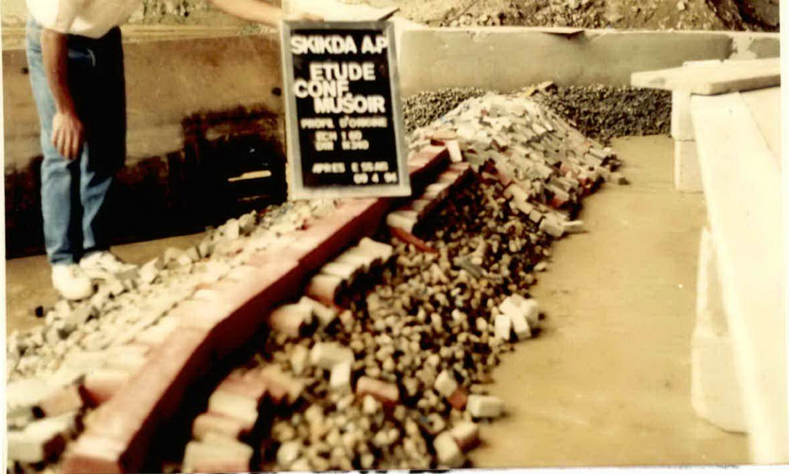
PHOTO 15: Vue du talus intérieur, profil d'origine, direction N31°O après essais. (Hs=9,32, Tp=15s). Désorganisation importante du talus.
