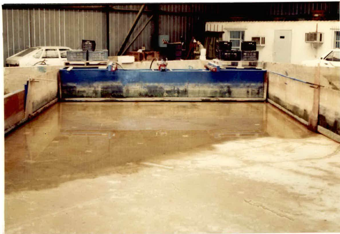
PHOTO 2 : Vue du batteur plan et panneaux d'orientation de la houle.
