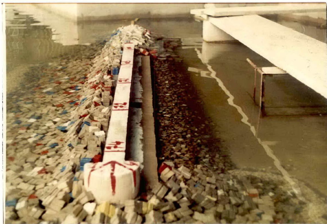
PHOTO 28 : Vue générale de l'ouvrage, variante 3 (Dégats cumulés = 0,27% après essais, profil très stable.
