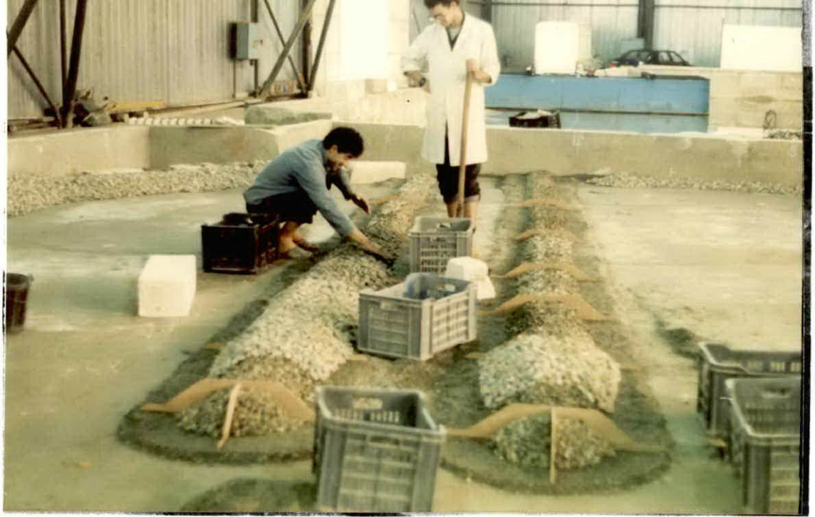
PHOTO 7 : Maquette d'un modèle type en construction. "OUED BOUDJIMAH".
