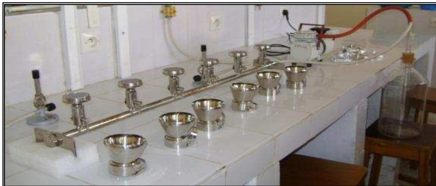
Photo III.20. Dispositif de l'appareil de filtration sur membrane.
