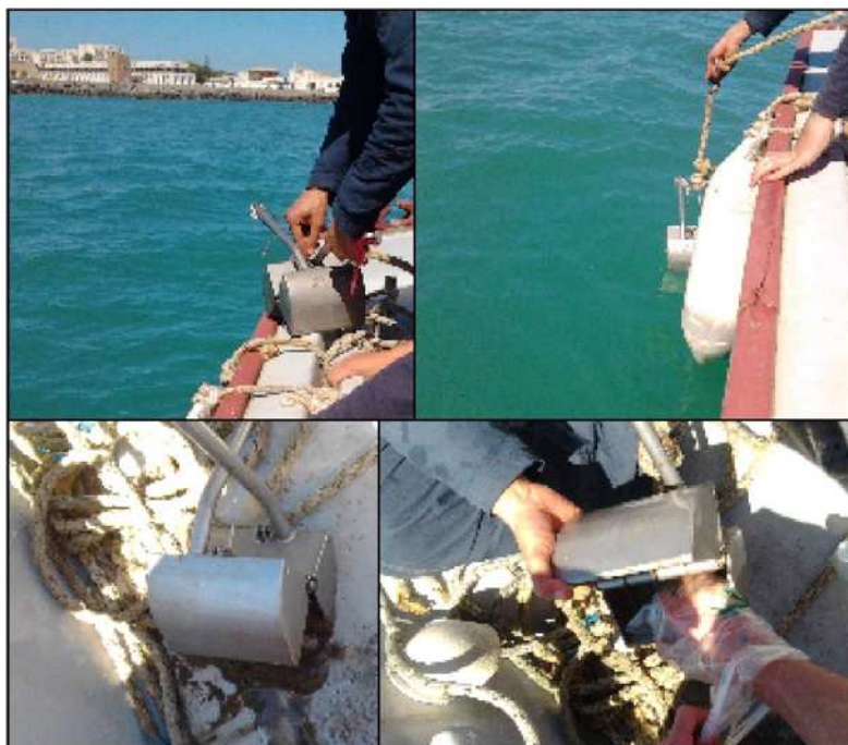
Figure 3.3 : Prélèvement de sédiment par une benne VAN VEEN
