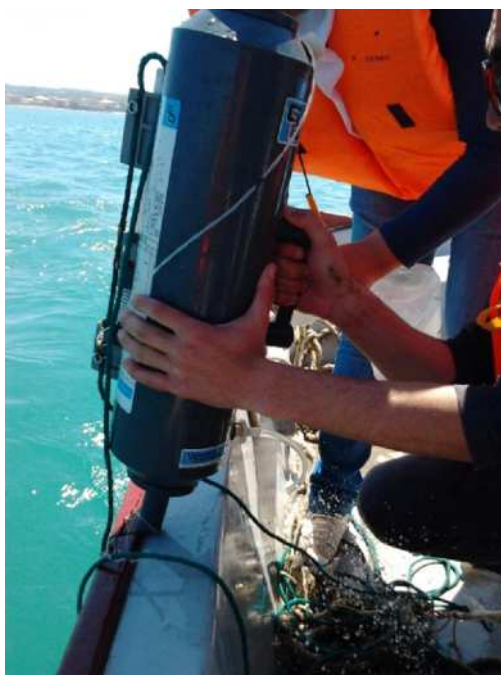
Figure 3.2 : Prélèvement d'eau de mer par une bouteille de prélèvement NISKIN
