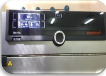
un séchage à l'étuve à 40°C pendant 48H
