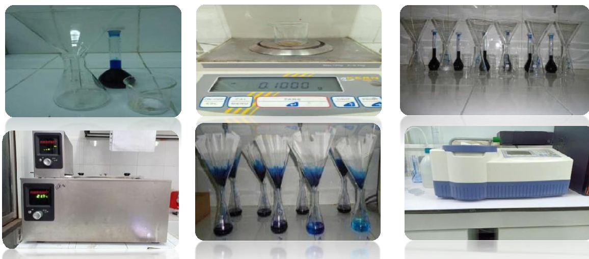
Figure 7: Les étapes de la cinétique d'adsorption du bleu de méthylène
