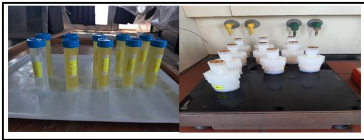
Figure 11 : Minéralisation des échantillons de biote.
