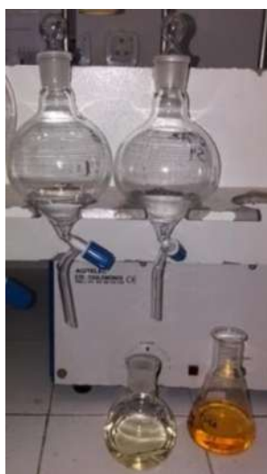
Figure III.8 Ampoule à décanter pour l'extraction liquide-liquide
