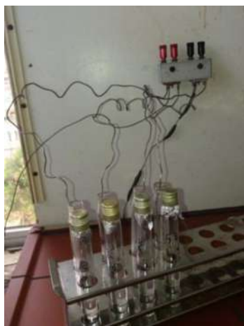
Figure III.11 Concentration sous jet d'azote
