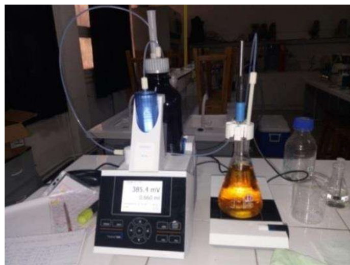
Figure III.18 Titreur automatique pour dosage de l'oxygène dissous
