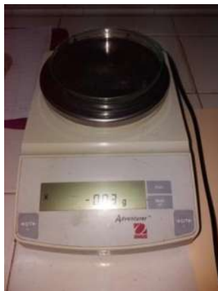
Figure III.16 Balance pour la pesée du sédiment pour la granulométrie
