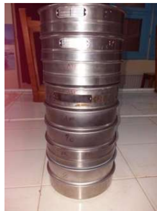
Figure III.17 Série de tamis pour l'étude granulométrique
