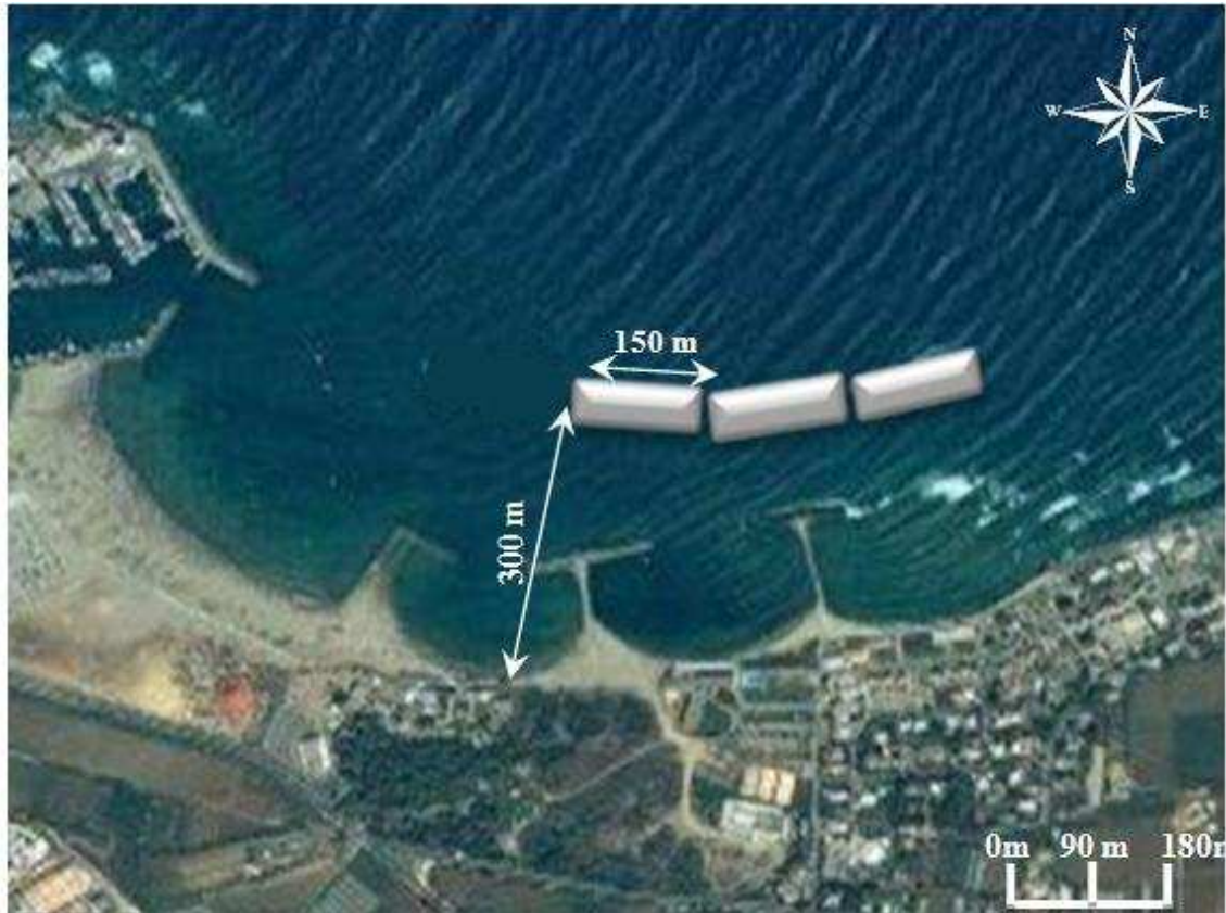
Figure n°III.10: Positionnement et dimensionnement des géotubes dans la zone de Sidi Fredj (Bing map, 2011).
