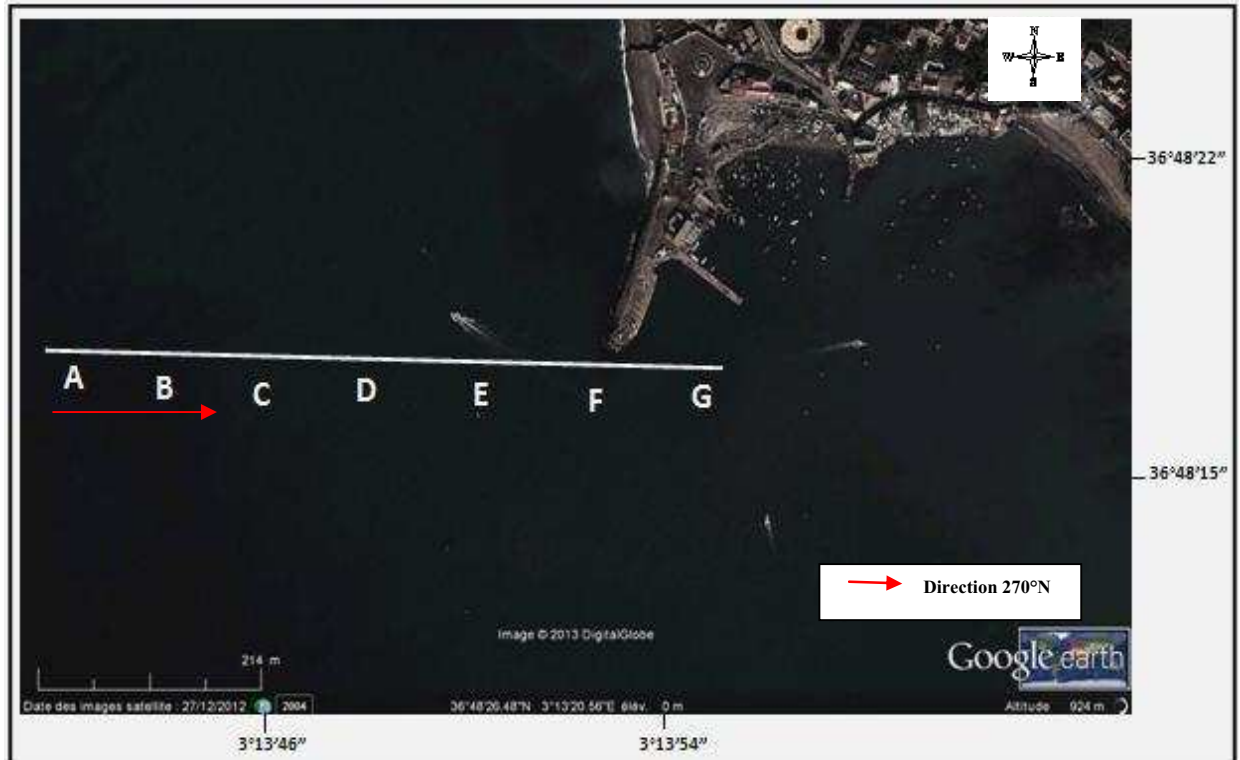
Figure N° III.1 : Profil utilisé pour le suivi des flux hydrodynamiques et sédimentaires pour les vagues de direction 270°N et de période de 10s
