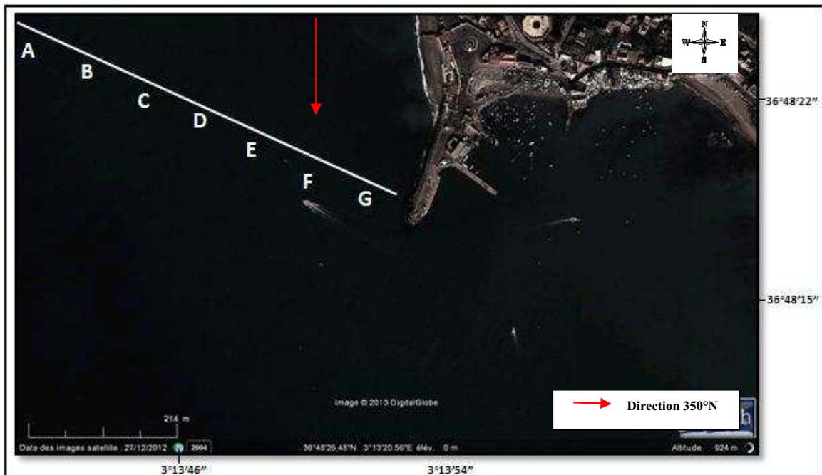
Figure N° III.3 : Profil utilisé pour le suivi des flux hydrodynamiques et sédimentaires pour les vagues de direction 350°N – Période 10s
