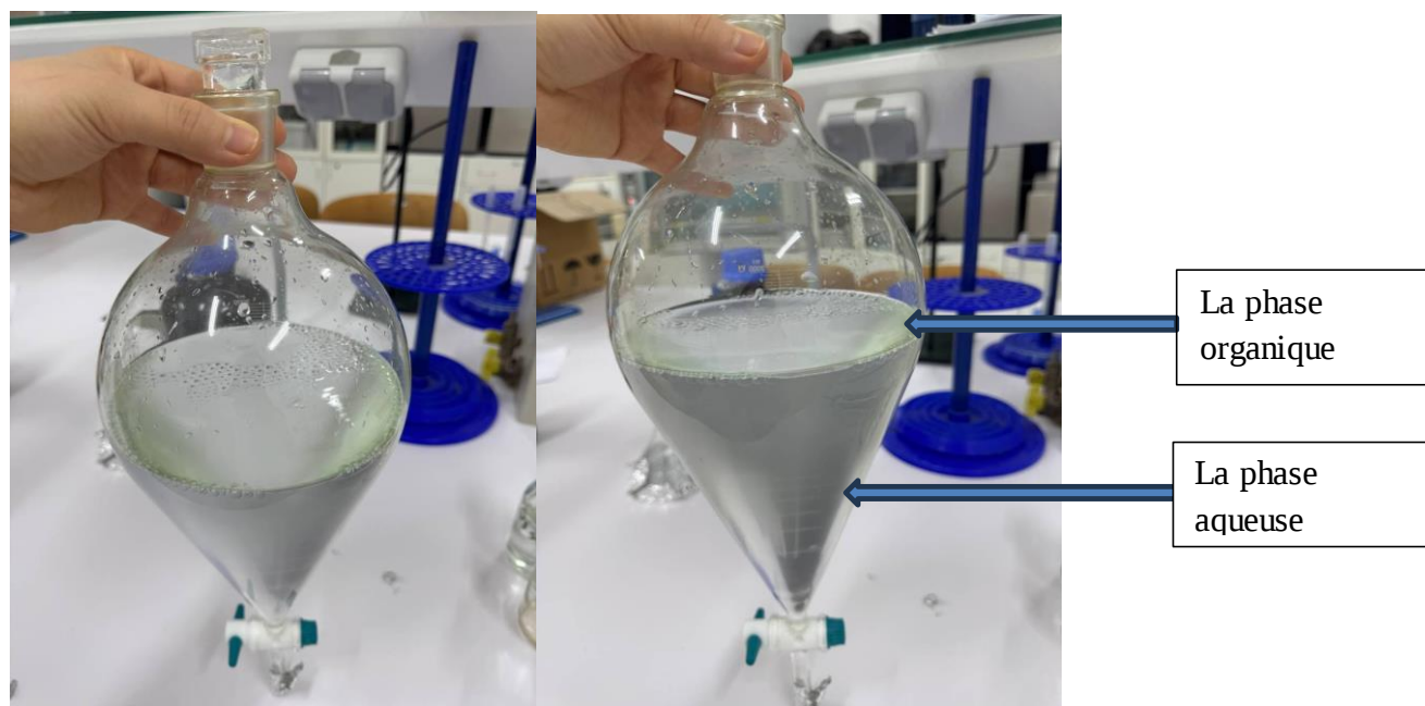
Figure 7: Extraction liquide-liquide : séparation de la phase organique et de la phase aqueuse
