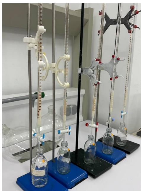
Figure 9: purification des extraits par chromatographie sur Florisil.
