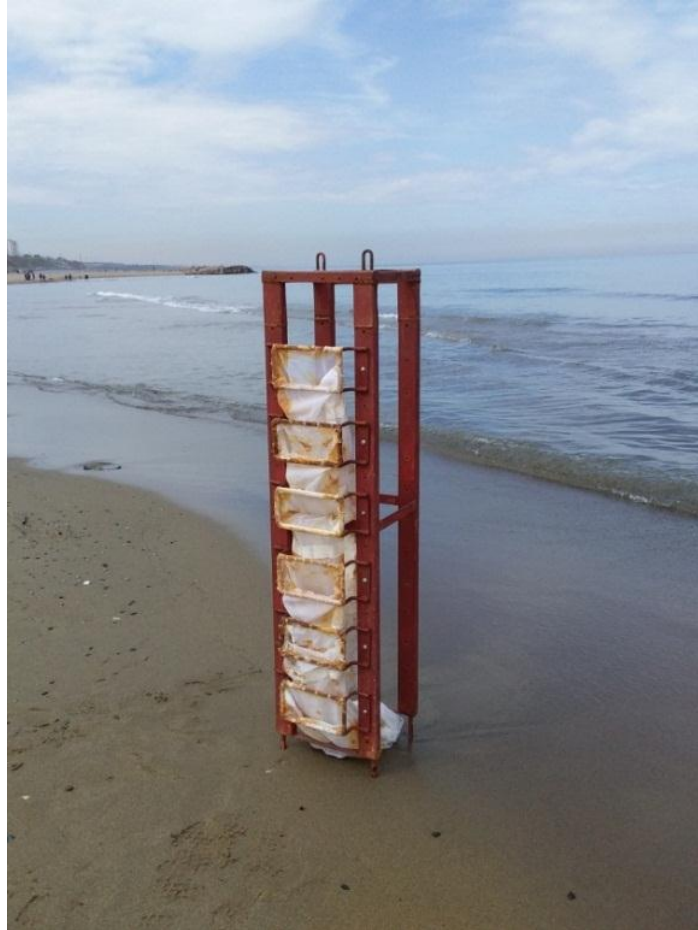
Figure III-9: Photo du piège à sédiments déployé sur site (Salem Cherif et al., 2019)
