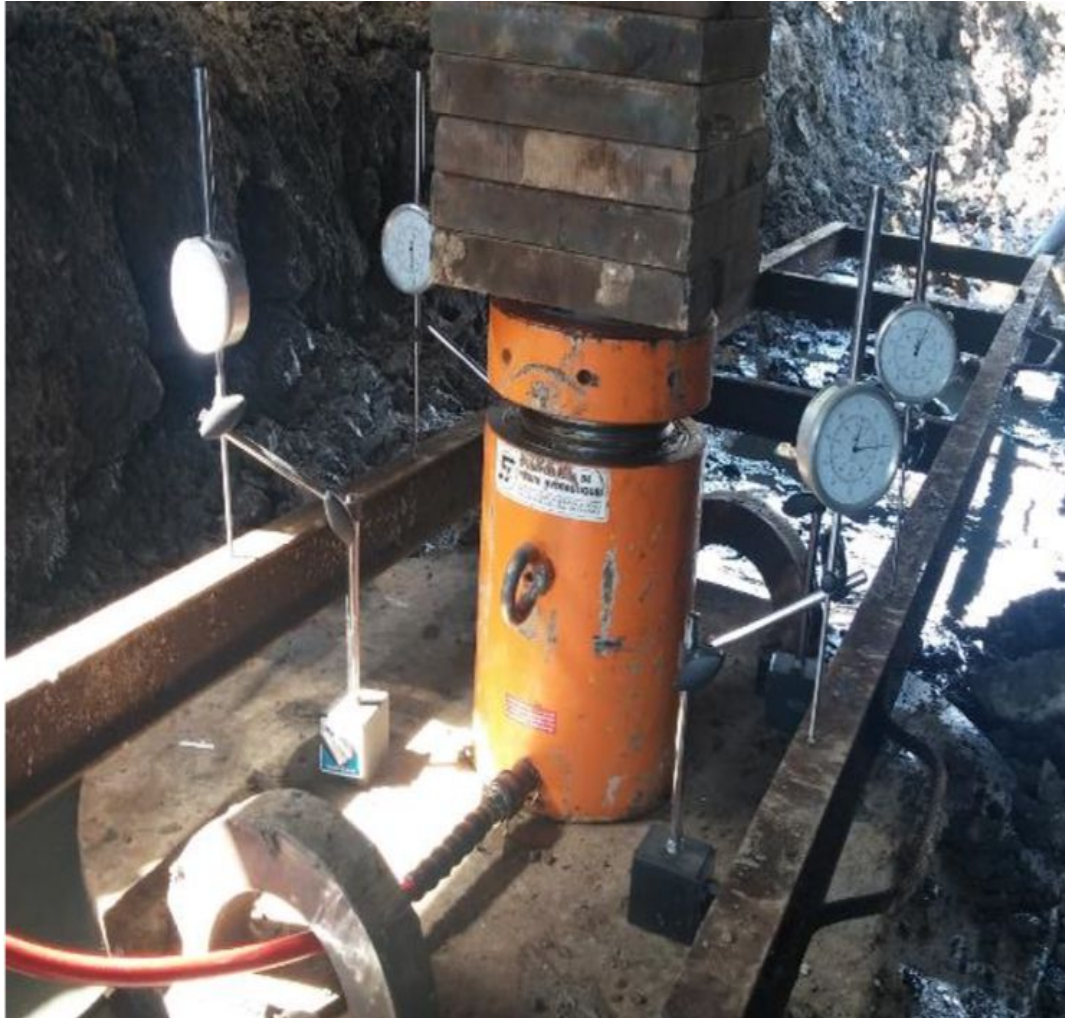
Figure IV. 2. Principe de l'essai de chargement
