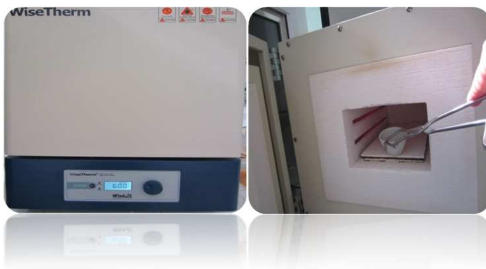
Figure 7 : four à moufle réglé à 600°C
