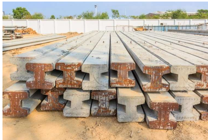
Figure 6 : pieux en béton précontraint [ https://fr.vecteezy.com/photo/1986875-pieux-en-beton-precontraint ]
