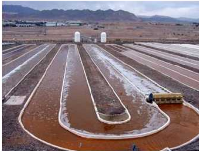
Figure 3 : Système de culture de type raceway (www.ifremer.fr).
