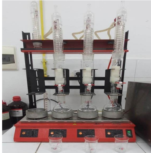
Figure II.14 Extraction des lipides (behr Labor-Technik) (Présente étude).
