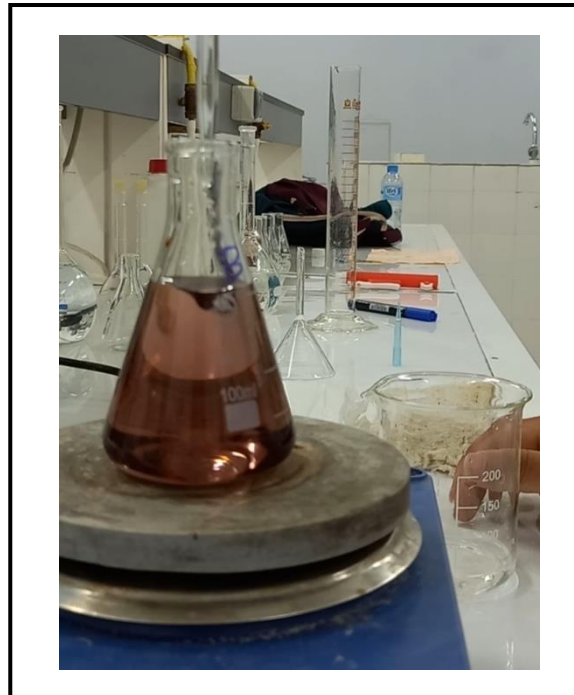
Figure-A 1-4 Titrage de l'acide sulfurique dans la phase de test de qualité nutritionnelle (dosage des protéines).
