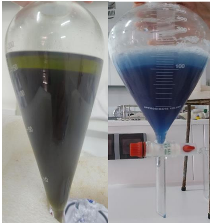
Figure 15 : les différentes séparations obtenues par la méthode appliquée aux extraits hydro alcoolique et aqueux.
