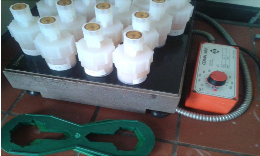
Figure 28 : Digestion des tissus de moules dans les godets en téflon sur la plaque chauffante.
