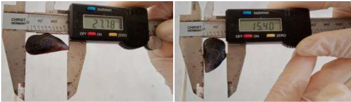
Figure 21: Mesures biométriques par le pied à coulisse.
