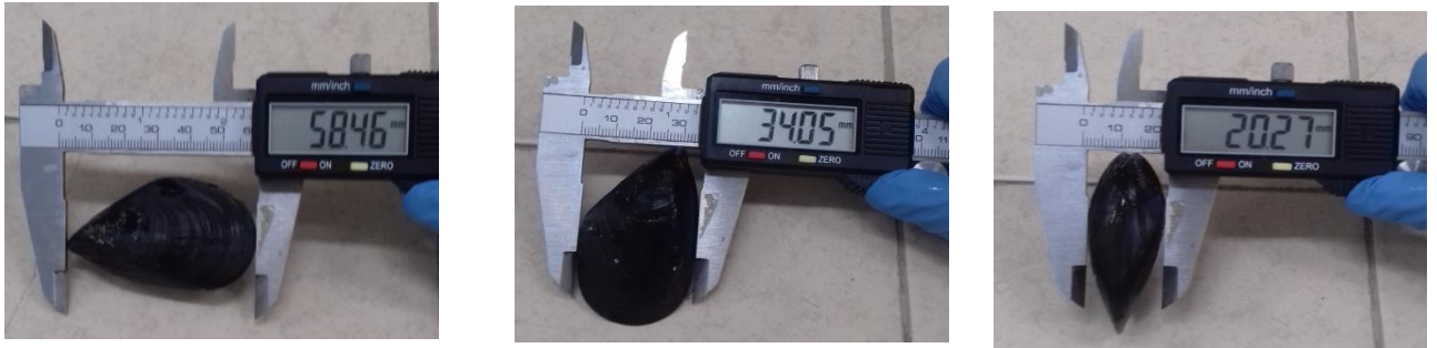
Figure 17: La méthode de mesure biométrique par le pied coulisse
