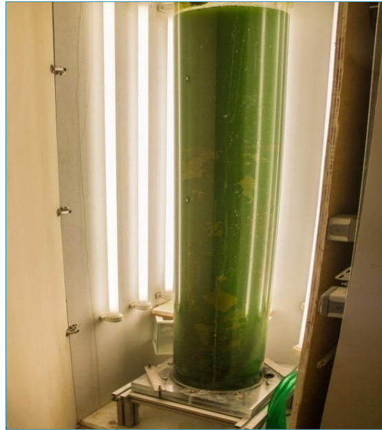
Figure I.11 : Photo-bioréacteur contenant une souche de spiruline originaire du Burkina Faso (Ahounou, 2017).
