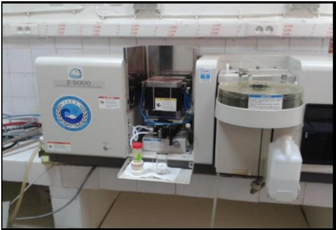
Figure 10 : Spectromètre d'absorption atomique de marque HITACHI, modèle Z-500.
