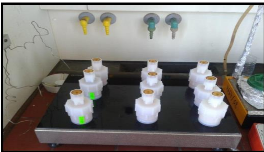
Figure 9: minéralisation sur plaque chauffante.
