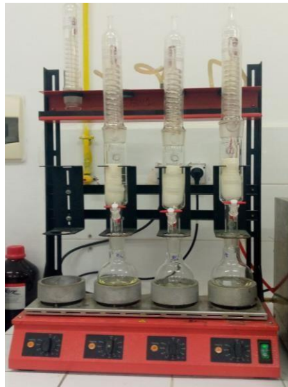
Figure 3-12 : Dispositif expérimental du dosage des lipides par la méthode de Soxhlet (au niveau de laboratoire Biochimie).
