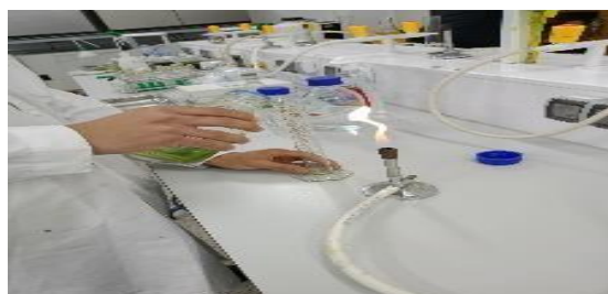
Figure 3-2 : Processus d'inoculation sous des conditions stérile (Bec bensen).
