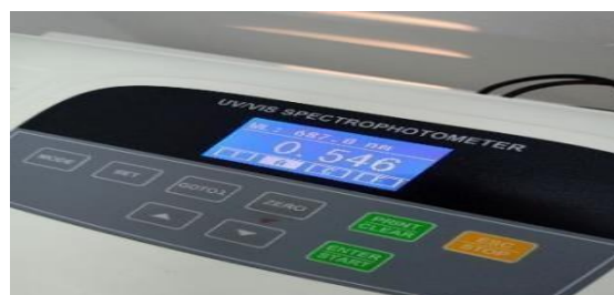
Figure 3-4: Spectrophotomètre utilisé pour la mesure de la densité optique (UV-51000 UV VIS).
