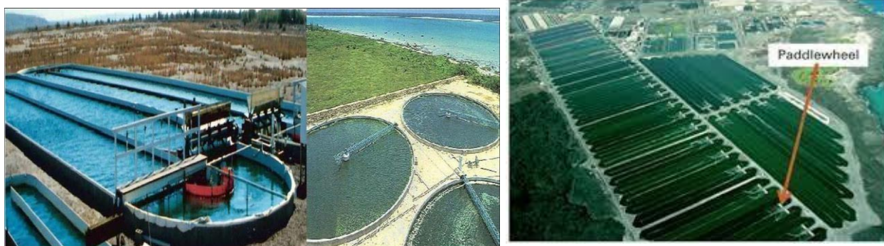
Figure 2-4 : les différents systèmes ouverts de culture des Microalgues dans le monde Système fermé (Photobioréacteurs).
