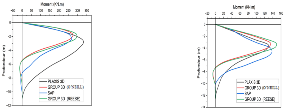
Figure 104: Graphe de comparaison des résultats du moment de a-pieu 15 et b-pieu 16 des logiciels (SAP, PLAXIS 3D et GROUP 3D avec la méthode de REESE et O'NEILL)
