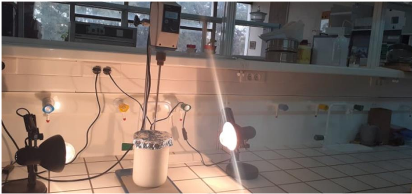
Figure I- 1 : Vieillissement du PVC sous l'effet de l'action de la mer, de l'agitation et d'irradiation lumineuse (I. Serrai & B. Hamdi).
