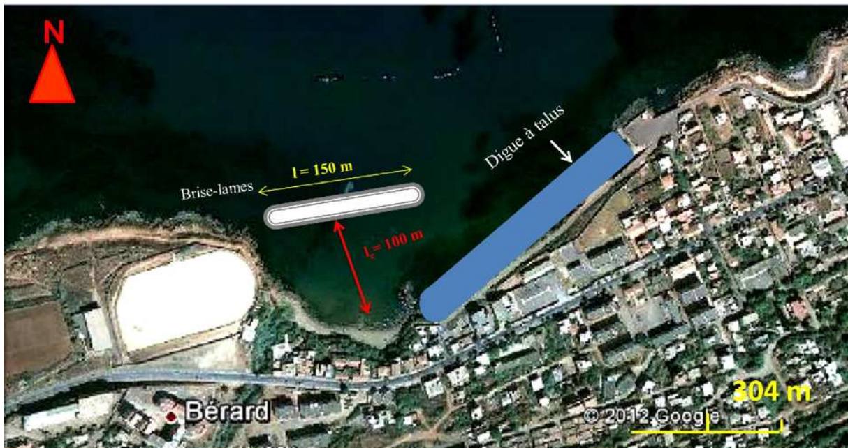
Figure 42 : Installation de l'ouvrage de protection sur la zone de Ain Tagourait
