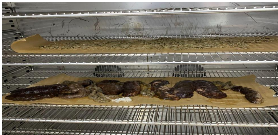
Figure 4. Séchage des échantillons d' Holothuria tubulosa et Eunicella singularis dans une étuve à 50\text{ }^{\circ}\text{C} .
