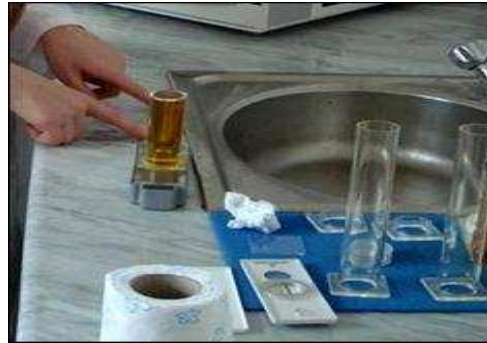
Un schéma et une image qui montrent les composants de la cuve d'UTERMÖHL.
