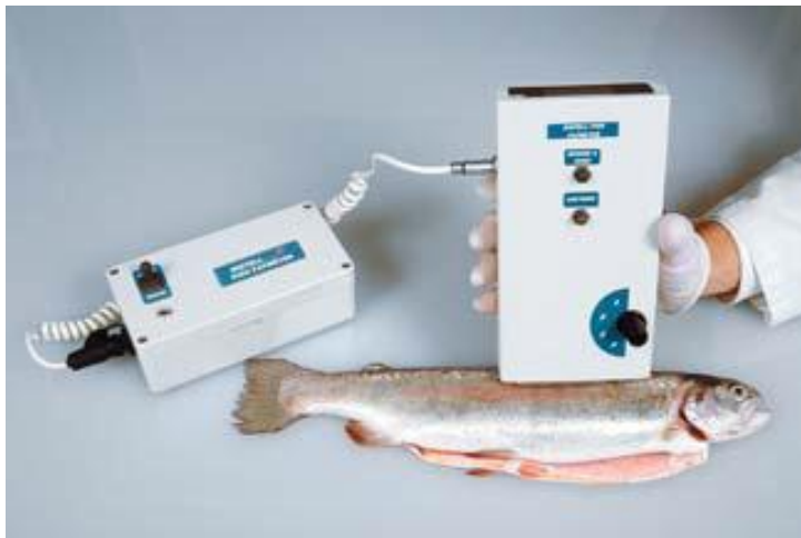
Figure n° 16 : Mesure de la teneur en lipides de la chair d'un poisson au moyen d'un appareil « Torry fish fatmeter » (Morin, 2002).
