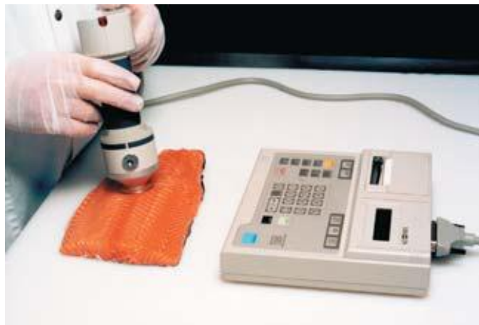
Figure n° 15: Mesure quantitative de la couleur d'un filet de salmonidé au moyen d'un colorimètre (Morin, 2002).
