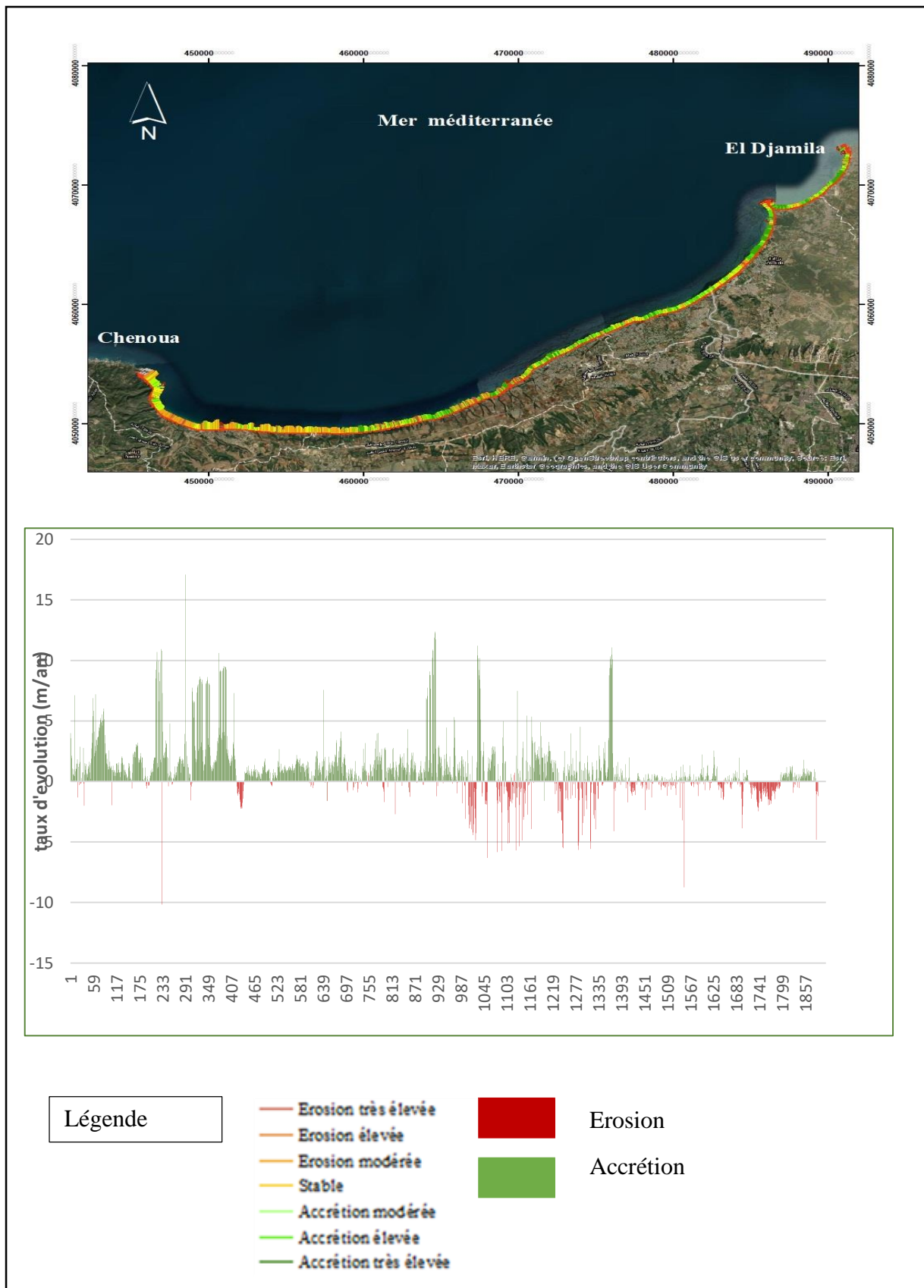
Figure 46:Évolution spatiotemporelle du trait de côte de la baie de Bou Ismail (2007-2022) : carte de répartition spatiale (haut) et histogramme du taux d'évolution par transect (bas)
