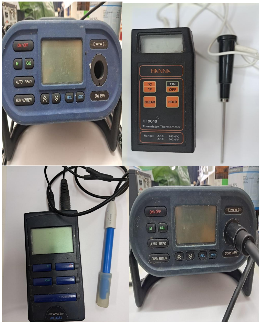
Figure 17 : appareils oxymètre de terrain, pH-mètre portable, thermomètre portable, Conductimètre de terrain.
