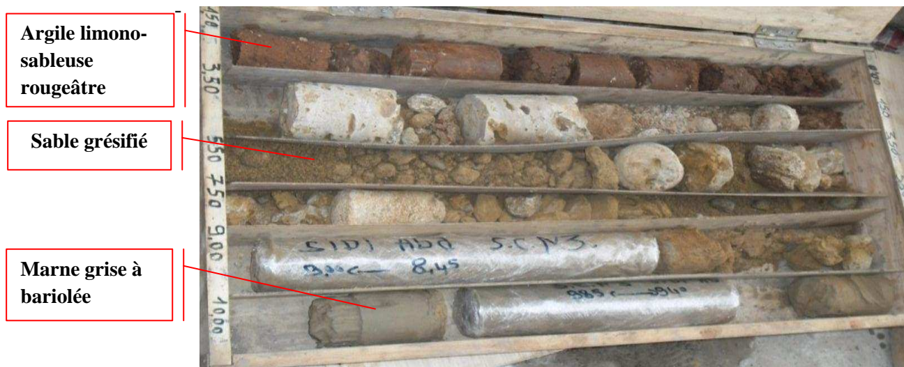
Figure 10 : Photo montrant des carottes de marnes bariolée, sable grésifié et d'argile rouge (LMTPB, 2013)
