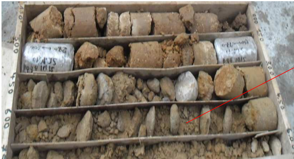
Figure 11 : Photo montrant des carottes de Grés (LMTPB, 2013)
