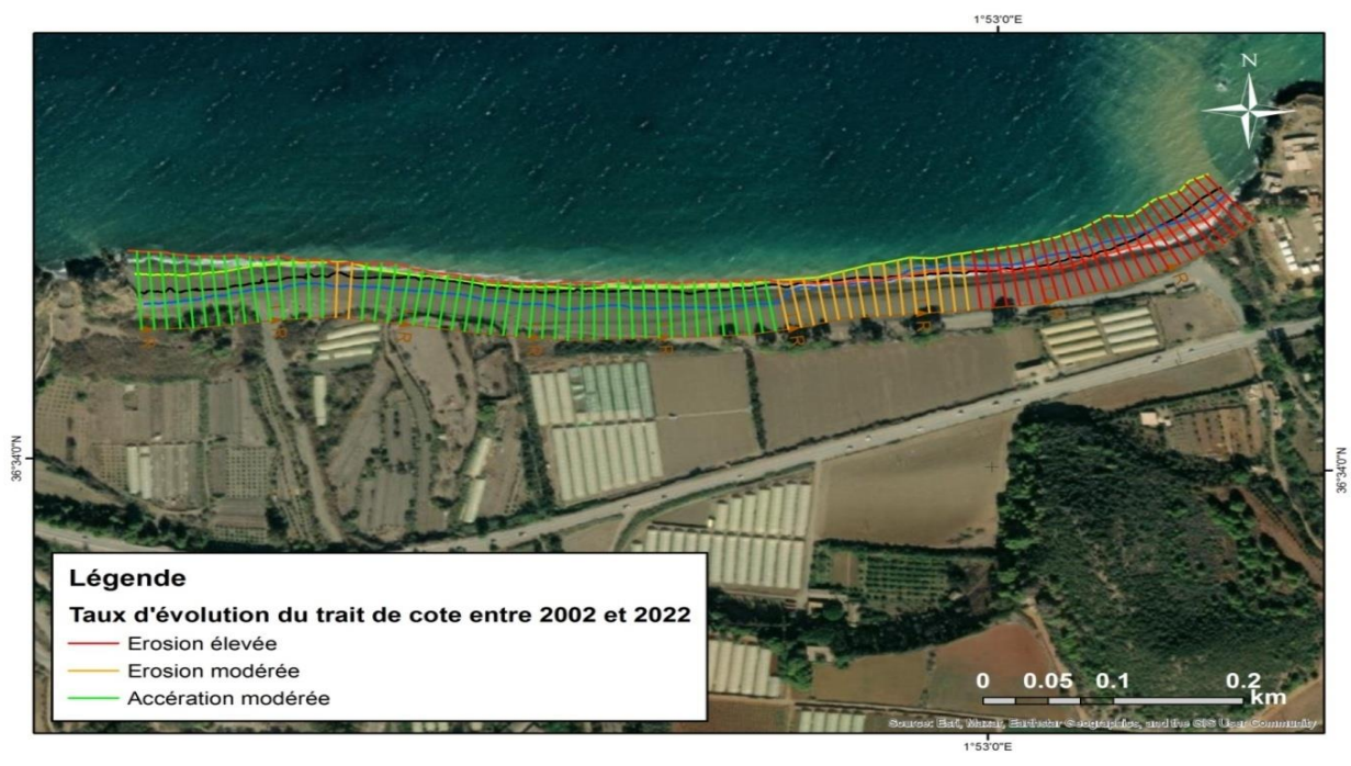
Figure IV.15 : Carte de taux d'évolution du trait de côte de la plage Bois Sacré Ouest entre 2002 et 2022
