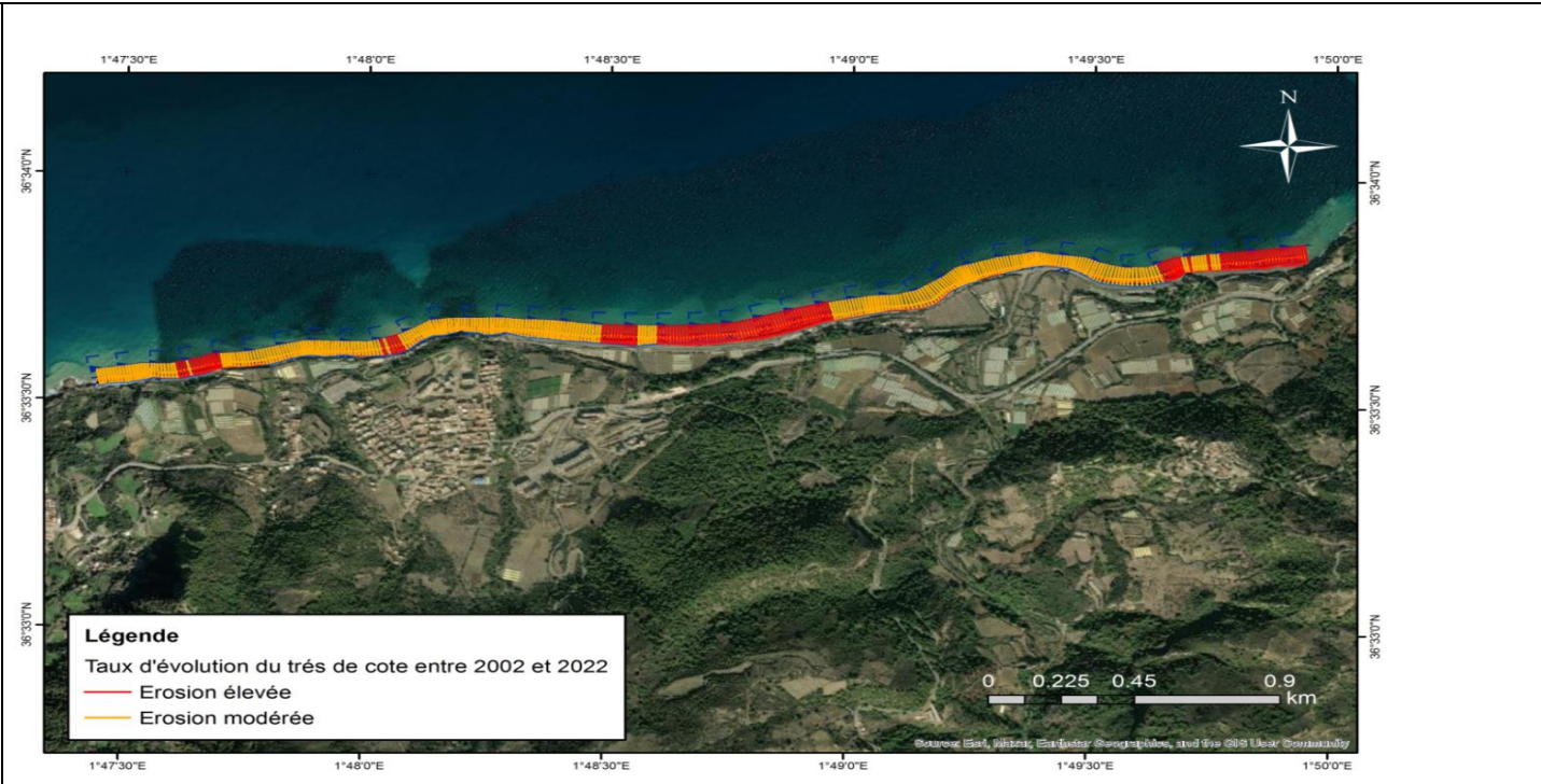
Figure IV.7 : Carte de taux d'évolution du trait de côte de plage Larhat entre 2002 et 2022
