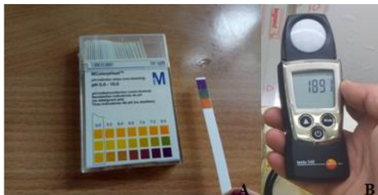
Figure III-2: Résultats des paramètres mesurés. A : Le pH obtenu ; B : L'intensité lumineuse obtenue.
