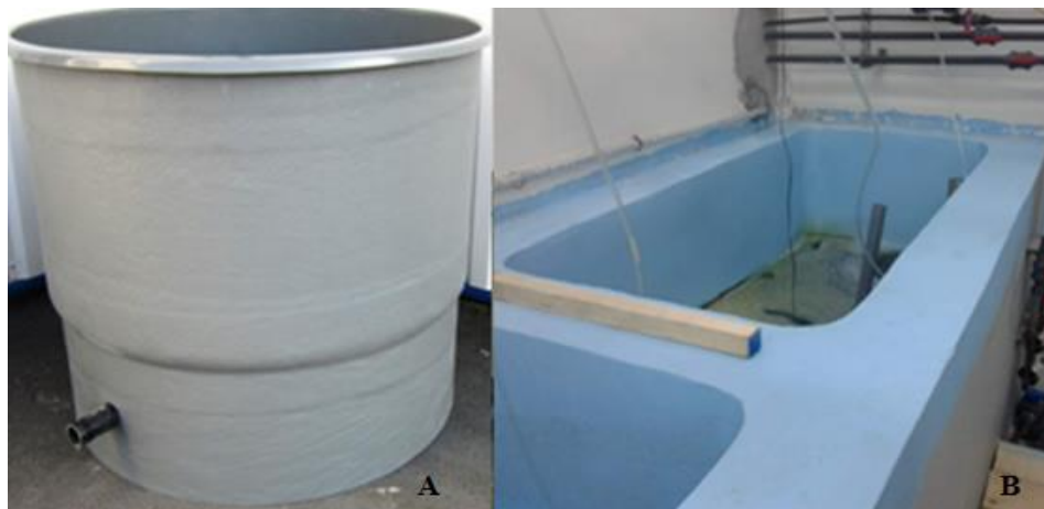
Figure II-10: Bassins de culture des rotifères (CNRDPA). A : Bassins en PP; B: Bassins en béton.
