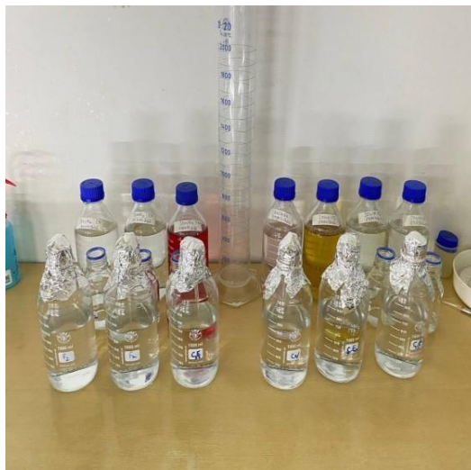
Figure II.5 : Bouteilles expérimentales recouvertes de papier aluminium avant autoclavage.
