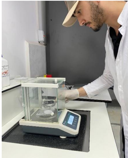
Figure II.11 : Pesée initiale des filtres pour la détermination de la biomasse sèche ( P_0 ).
