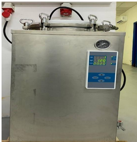
Figure II.6 : Autoclave utilisé pour la stérilisation des échantillons (120 °C, 20 min).
