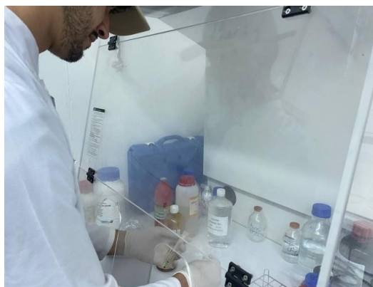
Figure II.16 : Extraction des pigments microalgaux au méthanol.
