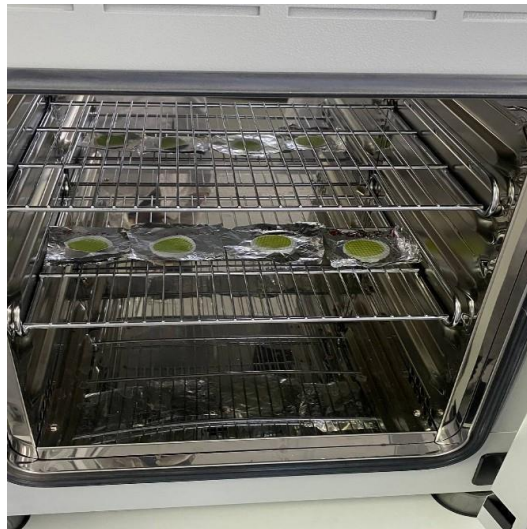
Figure II.13 : Séchage des filtres contenant la biomasse microalgale à 105 °C.
