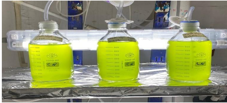
Figure II.8 : Mise en culture des microalgues dans des conditions contrôlées (lumière et aération).
