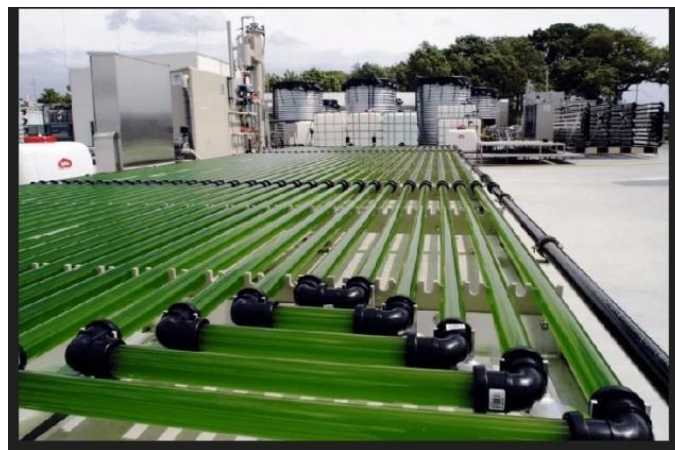
Figure I.8 : Photobioréacteur tubulaire (AlgaePARC).
