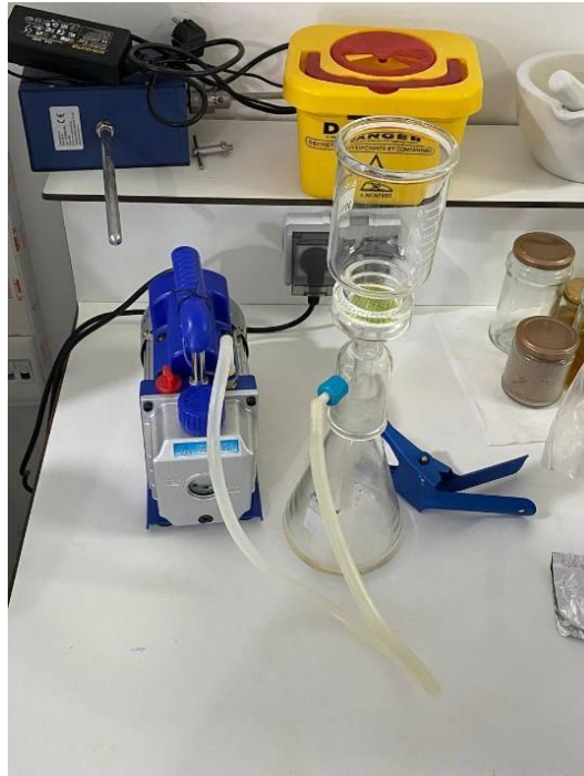
Figure II.12 : Filtration des échantillons de cultures microalgales sur membrane.
