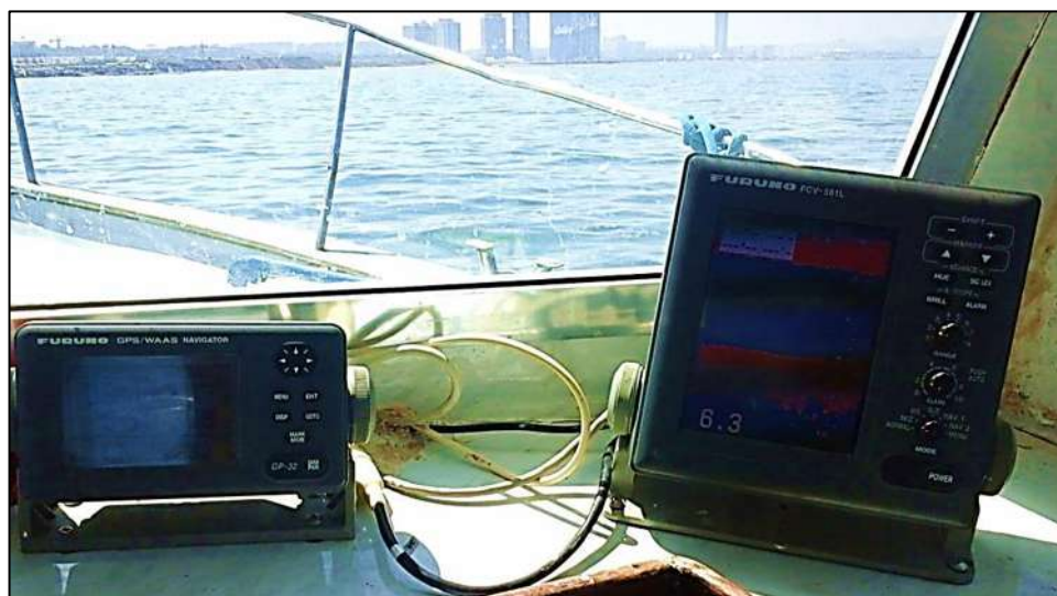
Photo V.3 : GPS et Échosondeur de type Furuno de l'embarcation Baba Aroudj
