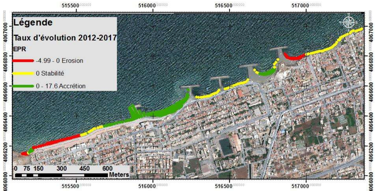
Figure IV.66: Vitesse d'évolution du trait de côte entre 2012 et 2017 dans la zone de Bordj El Kiffan
