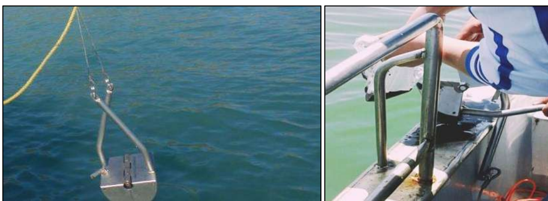
Photo V.4: Prélèvement des échantillons à l'aide de la benne Van Veen
